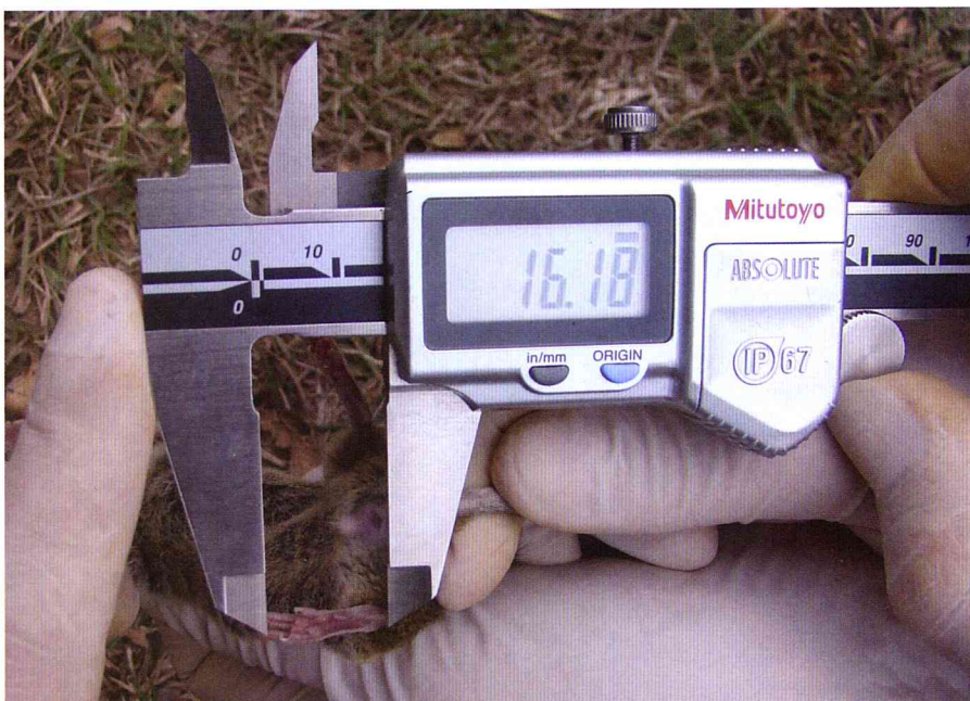
Medición de la pata trasera de un pequeño roedor con un calibre digital para determinar si muestra asimetrías superiores a las producidas al azar. La pata del animal, de 16,18mm, se distingue entre los brazos inferiores del instrumento.
